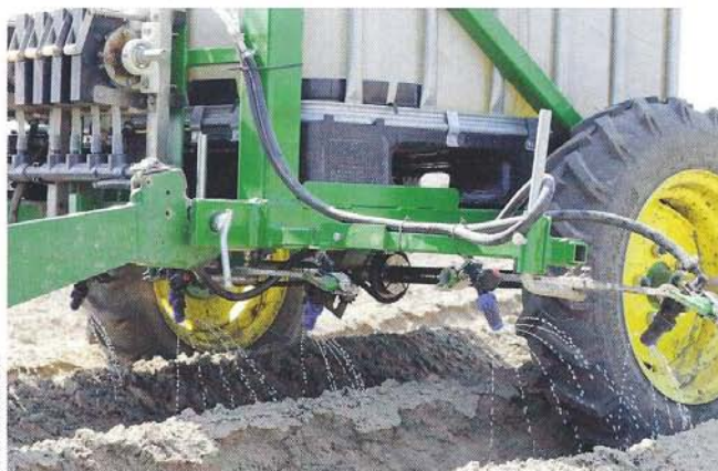
Rijenbemester van Bart Zijlmans. Dit is een van de typen machines die NCOR verhuurt. Deze machine is mechanisch aangedreven en past in de fronthead van de trekker.
