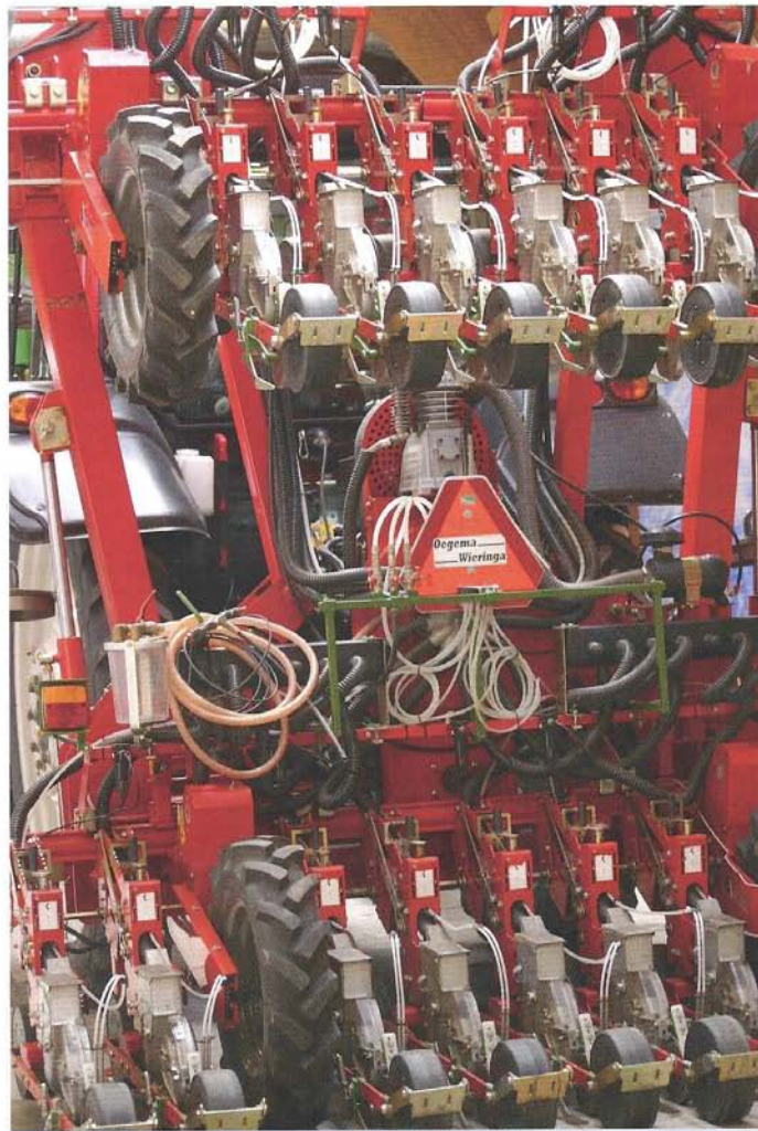
Een groeiend aantal telers past rijenbemesting toe. Met deze techniek kan zuiniger worden bemest.
